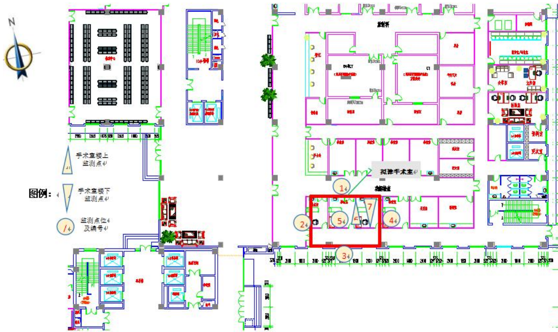
图 8-1 拟建 DSA 机房及周围 \gamma 辐射空气吸收剂量率监测点位图
